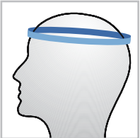
Vorsprungsfreier Innenraum (zur Vermeidung punktueller Belastung bei Beaufschlagung oder Anstoßen)
