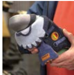
6 INSERIMENTO PUNTALE Toe insertion / Einsetzen Zehen- kappe
