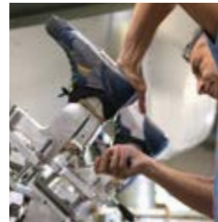
7 INIEZIONE SUOLA Sole injection / Einspritzen der Sohle
