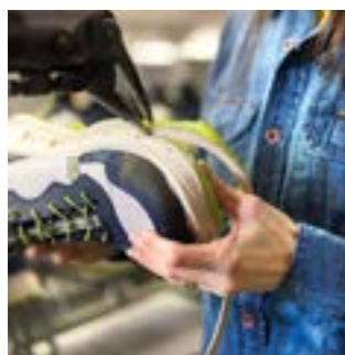
9 TAGLIO ECCESSI INIEZIONE Injection exceedance cutting / Schneiden überschüssiges Einspritzmaterial
